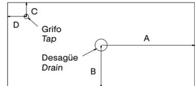
Indique las dimensiones y el diámetro del desagüe y del grifo en milímetros.
